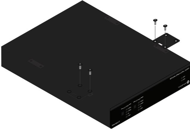
3. Monte la unidad utilizando los agujeros circulares, en cada placa de montaje. Los tornillos de montaje no están incluidos.
