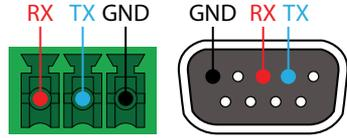
La salida de los pines estará determinada por el cable RS-232 y se conectará como RX (recepción), TX (transmisión) y  $\perp$  (tierra).
