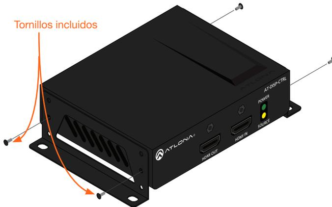
4. Monte la unidad utilizando los agujeros de forma ovalada, en cada soporte de montaje. Si se utiliza una superficie de cartón-yeso, se recomienda utilizar un tornillo de cartón-yeso del nº 6.
