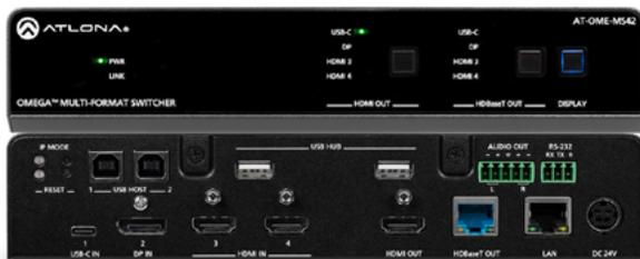
La salida HDBaseT del OME-MS42 se conecta a un receptor **AT-OME-EX-RX** de Atlona y permite la extensión de varias señales por hasta 100 metros (330 pies) a través de un solo cable blindado Categoría 6A. Esto incluye contenido de video de la computadora portátil o PC de sala para el proyector, señales de control para el proyector y datos USB para la cámara PTZ AT-HDVS-CAM de Atlona dedicada al instructor.
