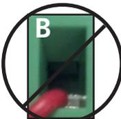
Los conectores de tornillo cautivo tienen una barra de contacto que se ajusta para comprimir el cable contra la placa de contacto superior. Use los tornillos en la parte superior del conector para comprimir el cable contra la placa de contacto.
